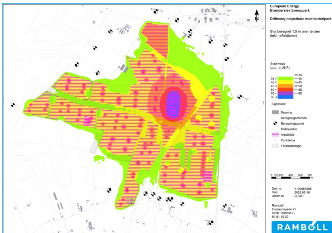
Figur 22-4. Støjdbredelsen fra solceller og batterianlæg i natperioden.
